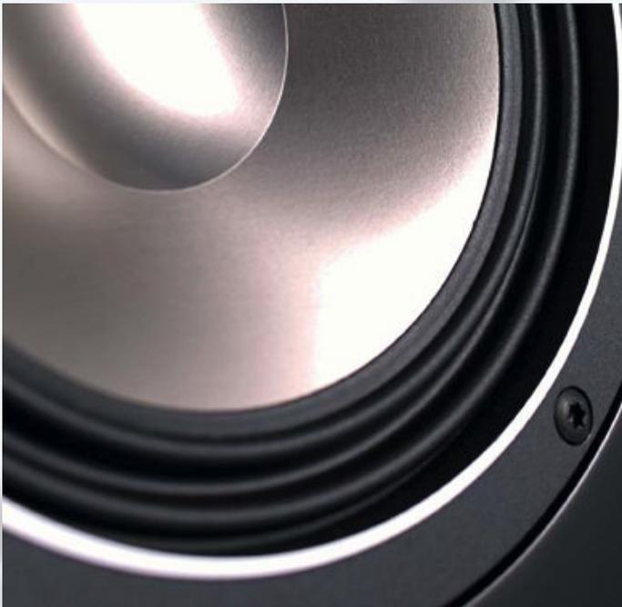
Die Wave-Sicke der Mittel- und Tieftöner ist in der neuesten Generation dreifach gefaltet. Dies soll ein kontrolliertes, fehlerfreies Ein- und Ausschwingverhalten bis hin zum Maximalhub ermöglichen.
